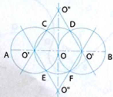
**2** Le rette passanti per i punti  $O'C$ ,  $O'E$ ,  $O'D$  e  $O'F$  trovano i centri mancanti  $O'''$  e  $O''''$  e la posizione dei punti di raccordo G, I, H, L; con centri in  $O'''$  e apertura del compasso  $O'''L$  e centri in  $O''''$  e apertura  $O''''L$ , si disegna la figura cercata.
